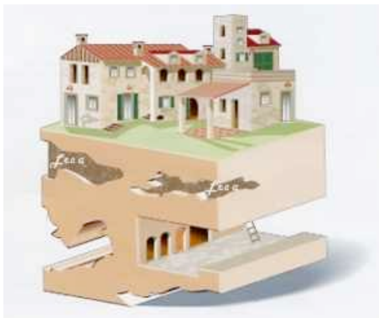
Fig. 10: Schema semplificato delle cavità sottostanti un edificio
